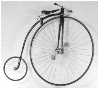
**Figura 9.** Grand Bi de radios metálicos
