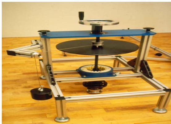
Figura 6. Máquina de fricción rotacional.
